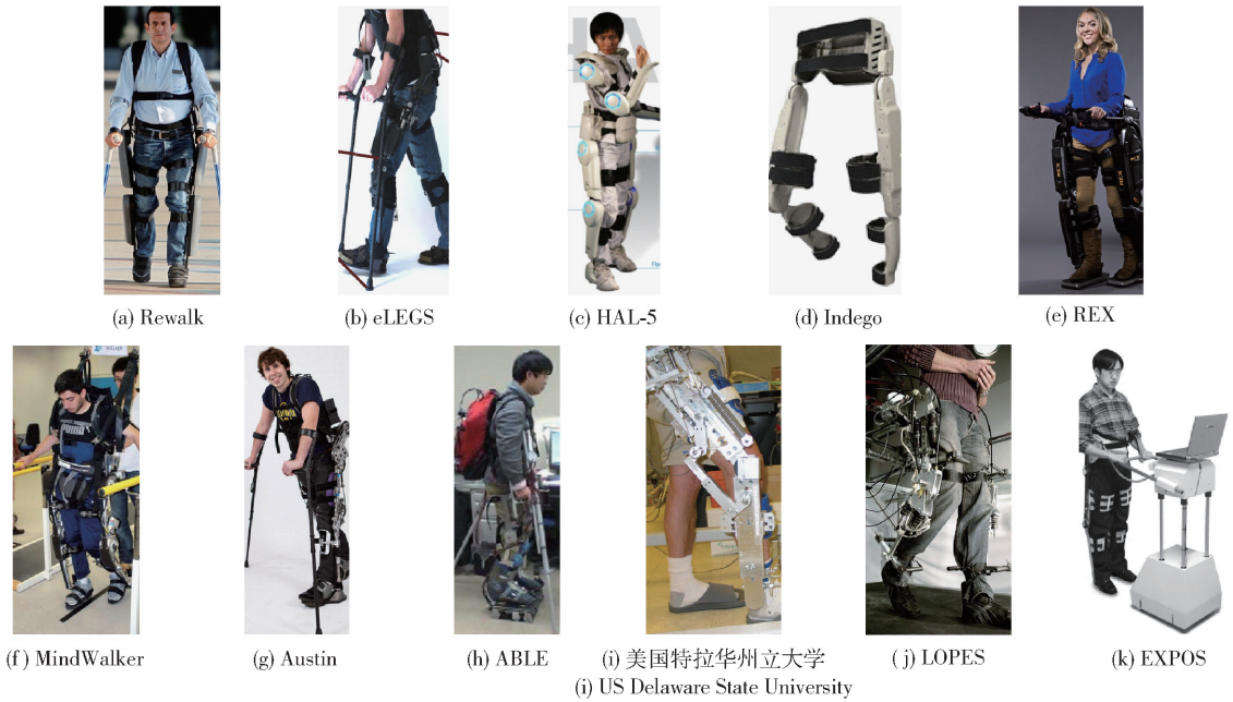
图 2 国外康复外骨骼助力机器人
